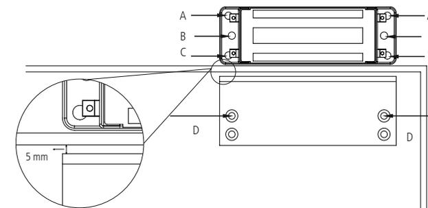
**Obs.:** na fechadura existem 3 pares de furos como opção de fixação. No suporte auxiliar recomendamos utilizar as furações "D".
