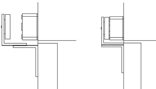
Exemplo de instalação em porta de divisória, que abre para dentro, e em batente de divisória:
