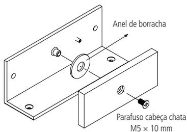
5. Se necessário, ajuste a distância entre o suporte do blanque e a fechadura (máx. 20 mm).
