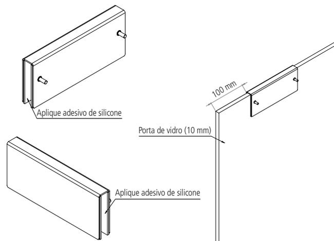
3. Instale o outro suporte na bandeira de vidro, aplique o adesivo de silicone em toda a superfície interna da cortiça e alinhe o suporte da bandeira com base no suporte instalado na porta.
