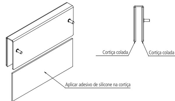
2. Após a secagem do silicone e a fixação da cortiça no suporte, aplique o adesivo de silicone em toda a superfície interna da cortiça e coloque o suporte na porta de vidro;
