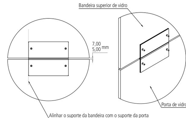
Para o melhor rendimento de tração da fechadura, respeite os limites de distância entre a porta e a bandeira (limite máximo de 7 mm e o limite mínimo em 5 mm).
