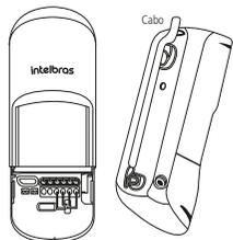
**Obs.:** para facilitar a instalação utilize os rebaixos na tampa traseira para passagem dos cabos.
