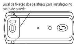
Local de fixação dos parafusos para instalação no canto de parede
