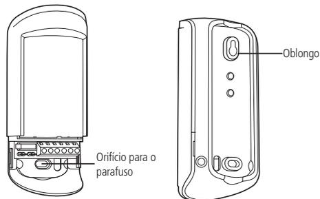
» **Passo 2.1:** caso a instalação seja feita no canto da parede utilize os furos indicados na tampa posterior.
