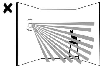
**Obs.:** antes de iniciar a instalação, é necessário definir a altura em que o sensor será posicionado, que pode variar de 1,80 a 2,2 m, conforme a tabela do item 7. Instalação deste manual.
